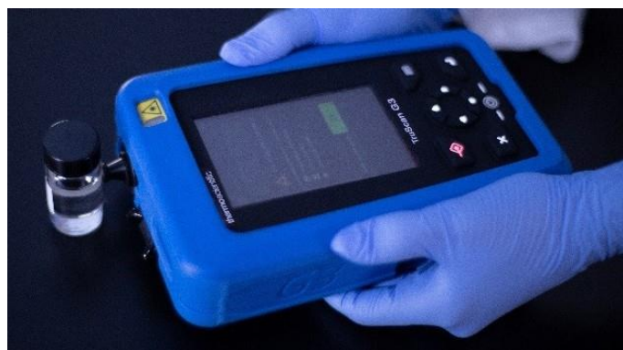
Рис 1. Портативна система перевірки ідентичності матеріалів TruScan G3 на основі технології раманівської спектроскопії - показана з аксесуарами на верхньому зображенні.
